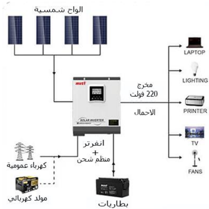
شكل (٢-١٦) يوضح مكونات منظومة الطاقة الشمسية "المصدر محرك البحث GOOGLE"
